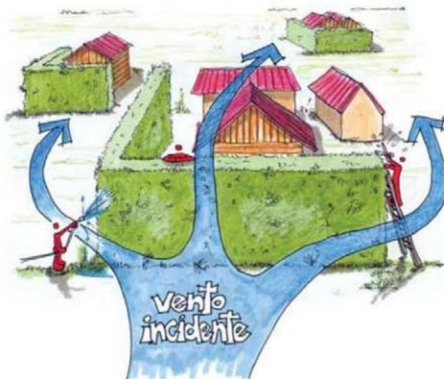
Figura 09: Ventilação natural - Fonte: Lamberts (2014).
